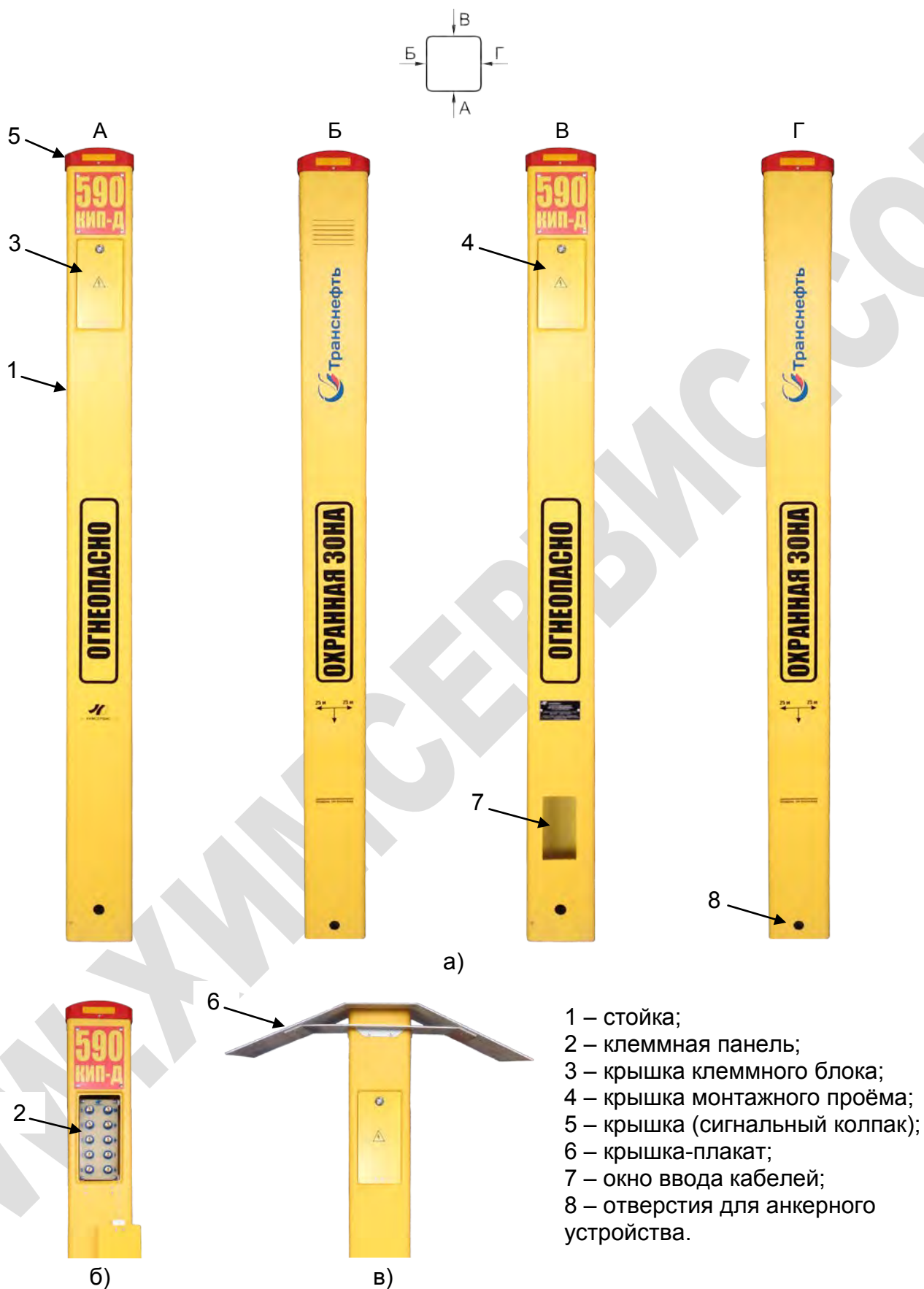
Рисунок 1 – Вид контрольно-измерительного пункта КИП ХС.ТН
